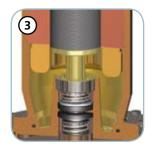
Двигатель в масляной ванне с тепловой защитой
