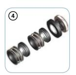
Механические уплотнения Два механических уплотнения из карборунда (2SiC) и одно механическое уплотнение из графито-глиноземной смеси (AL) для наивысшей надежности, даже в суровых условиях эксплуатации
